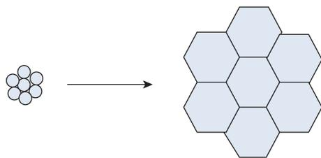
图 6 多波位炸裂波束示意图
