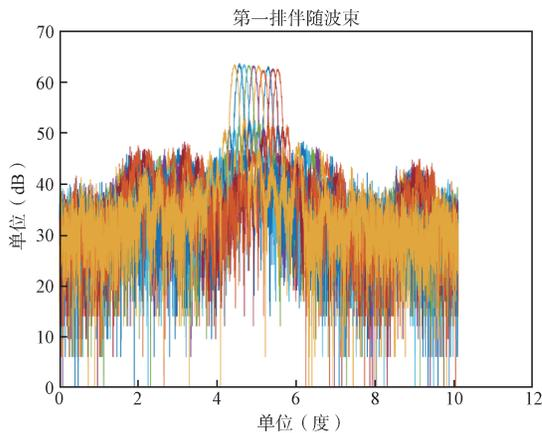
图 5 第一排偏馈波束方向图
