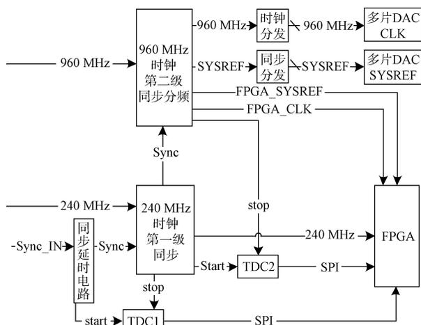
图 1 两级同步装置组成示意图
