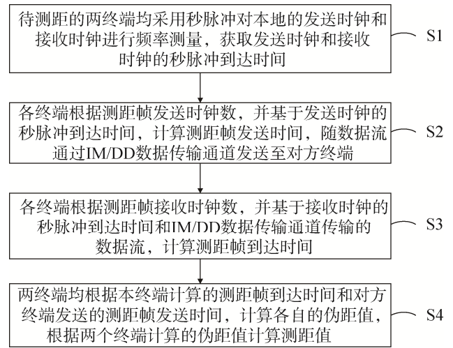
图 2 测距流程示意图 Fig. 2 Diagram of ranging process
