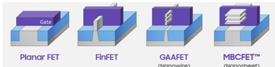
图 4 平面 MOSFET、FinFET 和 GAAFET 结构对比示意
