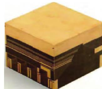
图 11 环氧树脂包封的多芯片射频组件微系统
