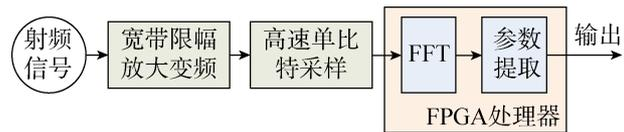
图 2 单比特接收机一般处理架构图
