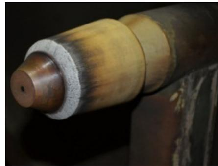
图 13 平头驻点热流模型
